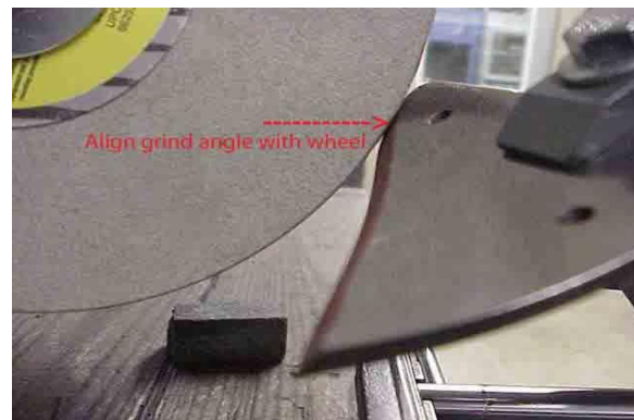
Align blade grind angle on heel of blade
